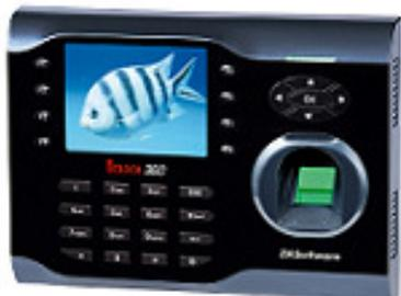
El ZKSoftware IClock360 es un **control de asistencia con pantalla de color TFT de 3.5 pulgadas multimedia**. Tiene **interfase gráfica que le ayuda a realizar una configuración simple más simple**. **Los usuarios pueden definir sus propias imágenes** de background. Incluye un poderoso software de control de asistencia gratuito. El IClock360 tiene la capacidad de operar de manera independiente y almacenar hasta 30,000 eventos.
